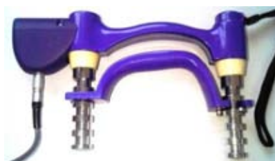
ภาพที่ 3.8 เครื่องวัดกำลังกล้ามเนื้อมือ Grip Dynamometer (G100)
