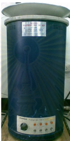
รูปที่ 3.3 อ่างทรายร้อน (Fluidized sand bath) ยี่ห้อ Omega รุ่น FSB-4
