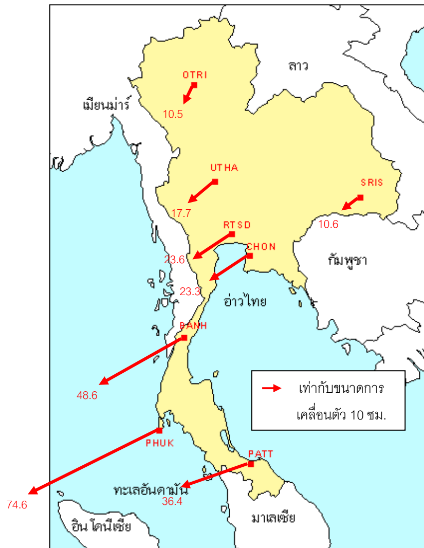
ภาพที่ 2.4 ขนาดการเคลื่อนตัวทางราบ ของหมวดหลักฐานในโครงข่ายอ้างอิงของประเทศไทย ที่เป็นผลจาก Co-seismic และ postseismic (ข้อมูลเดือน พฤศจิกายน พ.ศ.2553 (2010))
