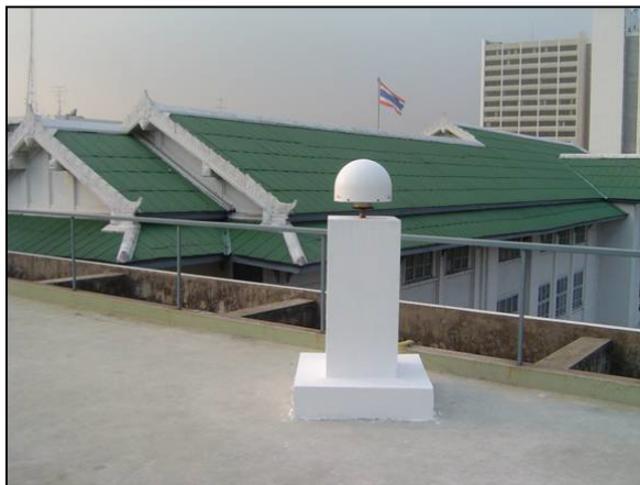
ภาพที่ 2.3 สถานีรับวัดดาวเทียม GPS แบบถาวร ณ โรงเรียนแผนที่ กรมแผนที่ทหาร
