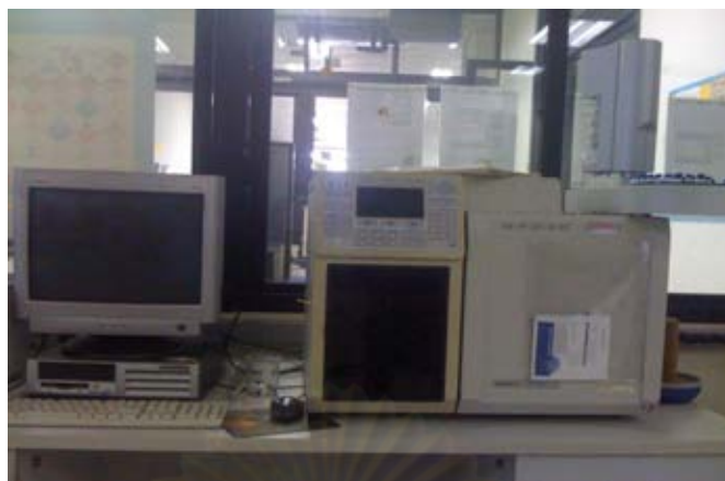
รูปที่ 3.9 เครื่องแก๊สโครมาโทกราฟ รุ่น CP-3800 ของ varian
