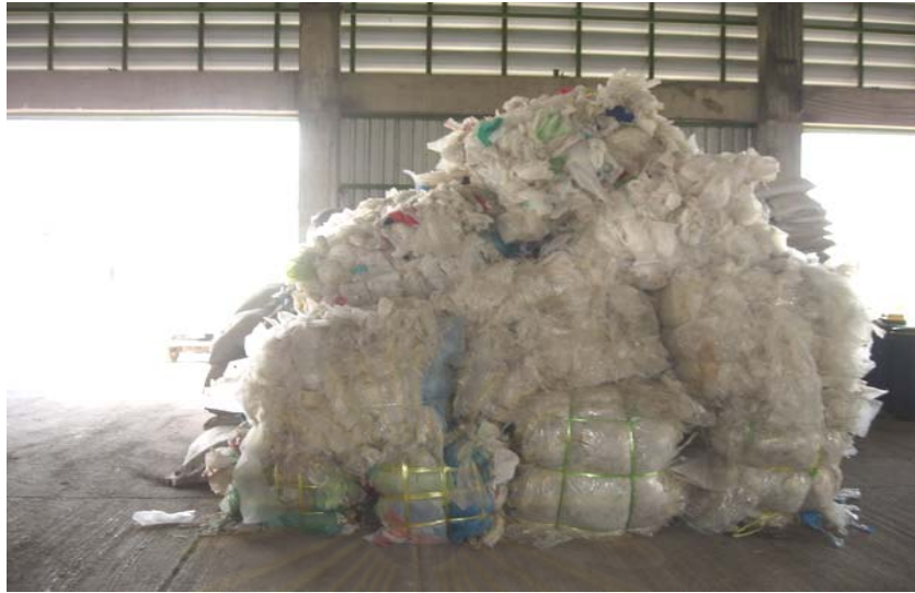
ภาพที่ 2-12 ขยะพลาสติกที่แยกออกจากขยะรวม มัดเป็นก้อน ๆ
