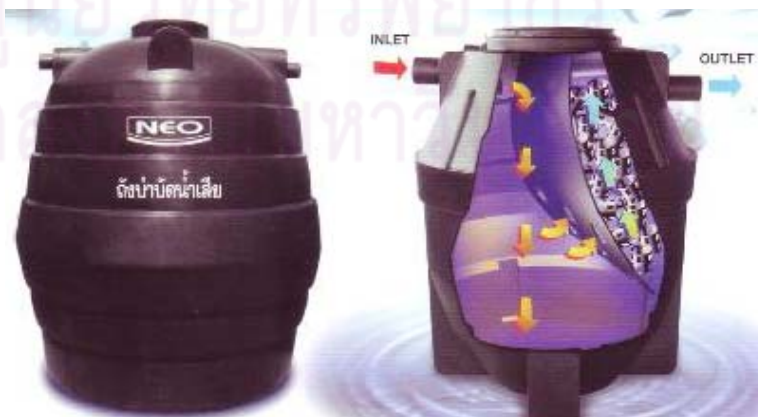
ภาพที่ 2-4 ถังบำบัดสำเร็จรูปแบบเกรอะและไม่เติมอากาศ (กระบีโปรเอ็นจีเนียร์จิง, 2553: ออนไลน์)
