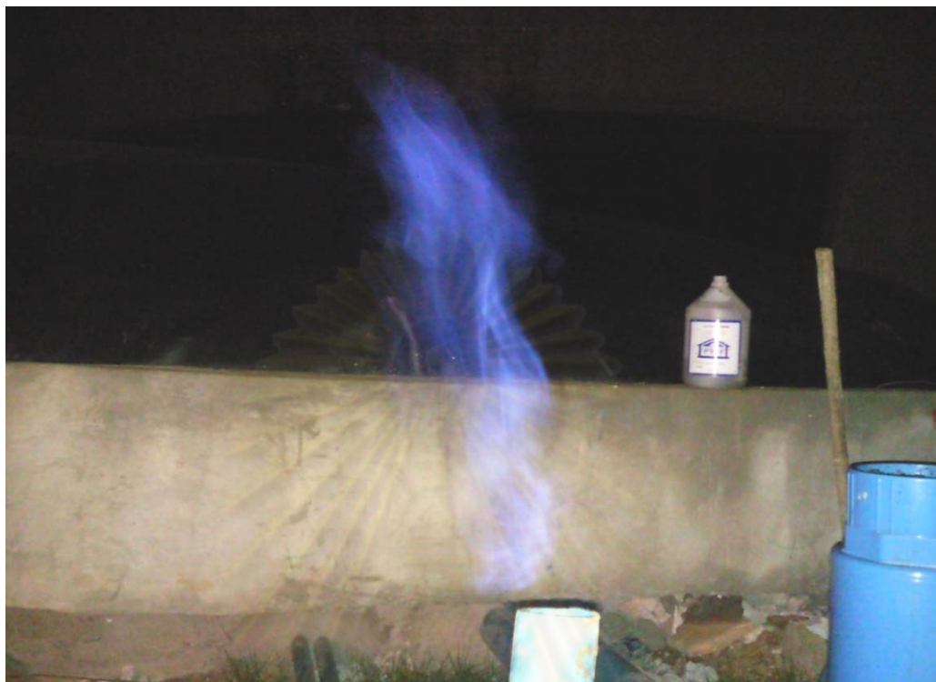
ภาพที่ 4-16 การทดสอบก๊าซชีวภาพจากบ่อบำบัด โดยการจุดไฟและตรวจความต่อเนื่อง
