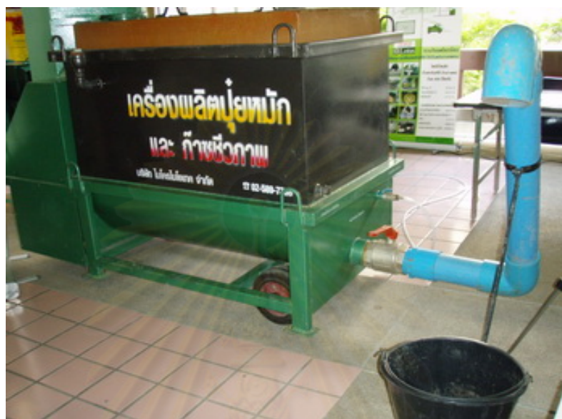
ภาพที่ 2-7 แสดงเครื่องผลิตปุ๋ยหมักและก๊าซชีวภาพ
