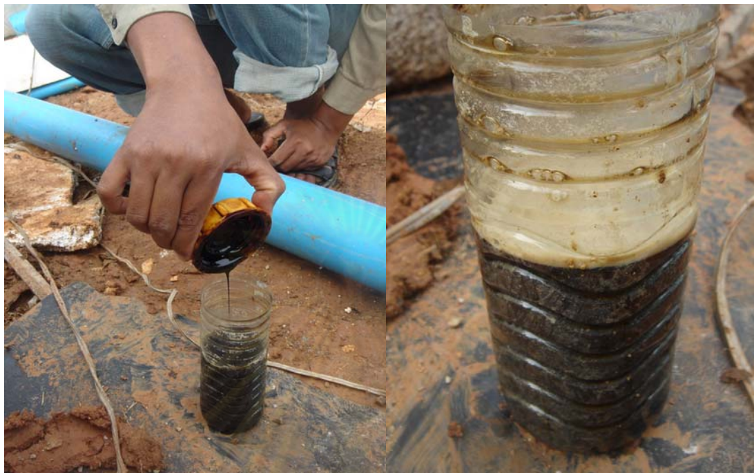
ภาพที่ 4-14 การทดสอบการทำงานของจุลินทรีย์ พบว่าเกิดฟองก๊าซทันที
