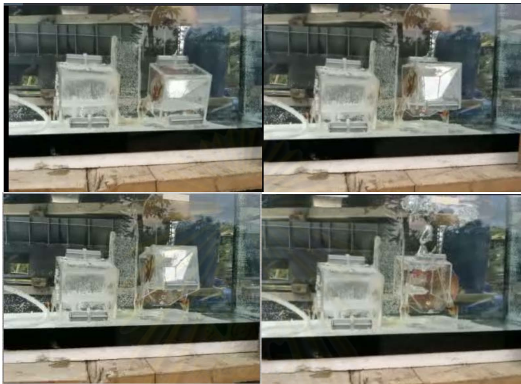
ภาพที่ 4-26 แสดงการทำงานของเครื่องนับก๊าซ ก๊าซจะค่อย ๆ ไหลดันเข้ามาได้น้ำ เข้าสู่กล่อง ไสรูปลีเหลี่ยม เมื่อก๊าซไหลเข้ามามากขึ้น กล่องไสรูปลีเหลี่ยมจะค่อย ๆ ยกตัวสูงขึ้น และหายไปใน ที่สุด เครื่องนับก๊าซจะนับเป็น 1 ครั้ง ปริมาตร 120 มิลลิลิตร
