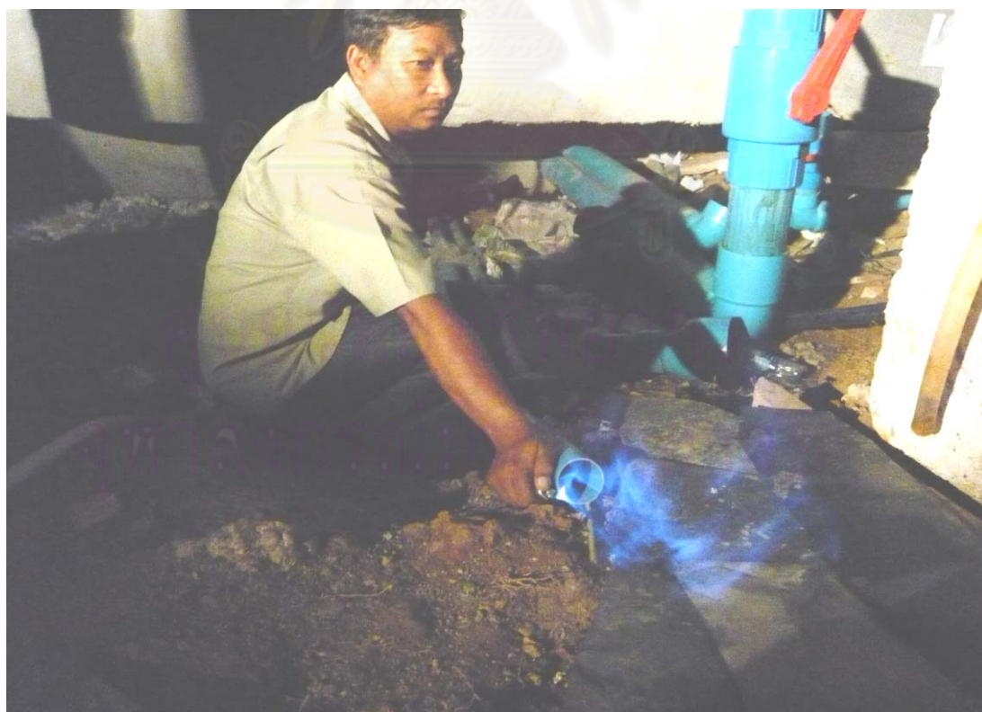
ภาพที่ 4-15 การทดสอบก๊าซชีวภาพจากบ่อบำบัด โดยการจุดไฟและตรวจความต่อเนื่อง
