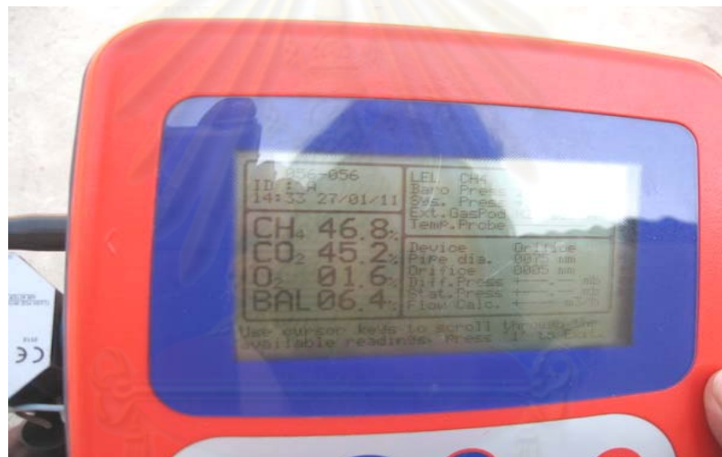
ภาพที่ 2-16 เครื่องมือตรวจวัดคุณภาพของก๊าซชีวภาพ วัดเปอร์เซ็นต์ของก๊าซมีเทน ก๊าซคาร์บอนไดออกไซด์ และก๊าซออกซิเจน
