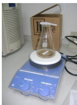
รูปที่ 3.6 ตัวอย่างตัวเร่งปฏิกิริยาที่ถูกใช้งานแล้วถูกทดลองการฟื้นฟูสภาพด้วยสารละลายโดยติดตั้งที่เครื่องกวน (Stirrer)
