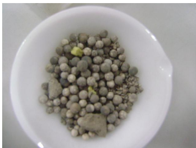
รูปที่ ข.2 รูปถ่ายของตัวเร่งปฏิกิริยาอะลูมินาที่ผ่านใช้งานแล้วแบบที่ 1
