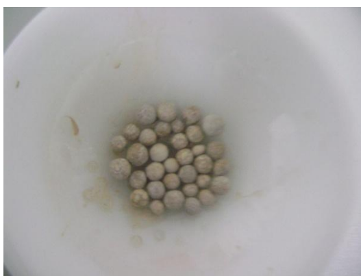
รูปที่ ข.5 รูปถ่ายของตัวเร่งปฏิกิริยาอะลูมินาแบบที่ 1 ที่ผ่านการชะล้างด้วยสารละลายแล้ว
