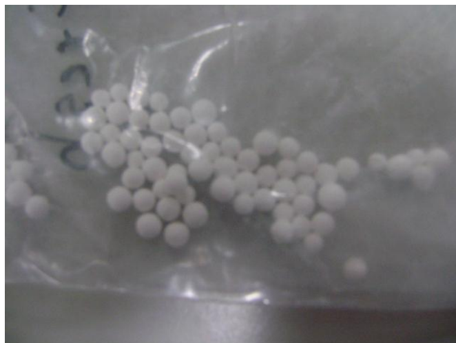
รูปที่ ข.1 รูปถ่ายของตัวเร่งปฏิกิริยาอะลูมินาที่ยังไม่ได้ผ่านการใช้งาน
