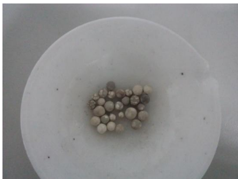
รูปที่ ข.3 รูปถ่ายของตัวเร่งปฏิกิริยาอะลูมินาที่ผ่านใช้งานแล้วแบบที่ 2
