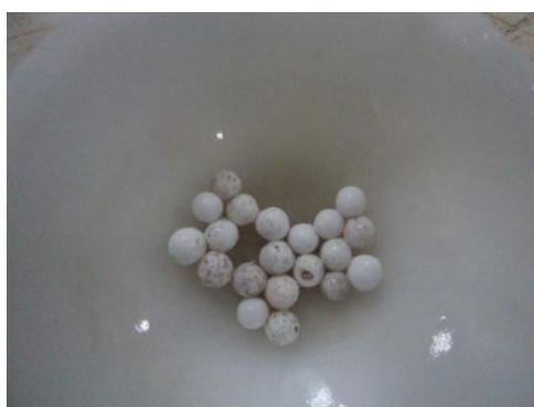
รูปที่ ข.7 รูปถ่ายของตัวเร่งปฏิกิริยาอะลูมินาแบบที่ 3 ที่ผ่านการชะล้างสารละลายแล้ว
