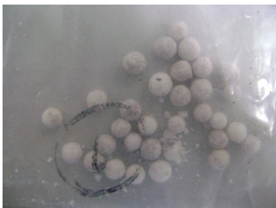
รูปที่ ข.4 รูปถ่ายของตัวเร่งปฏิกิริยาอะลูมินาที่ผ่านใช้งานแล้วแบบที่ 3
