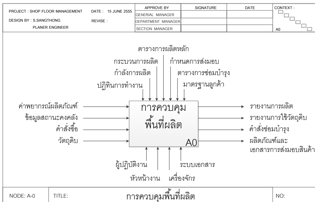
ภาพที่ 3 การวิเคราะห์กิจกรรมการควบคุมพื้นที่ผลิต
