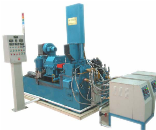
รูปที่ 3.2 เครื่องผสมแบบปิด Internal Mixer รุ่น Swang Fu machine Type E0
