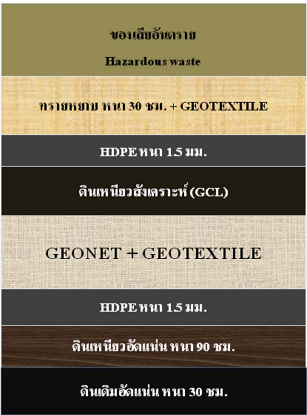
ภาพที่ 2-1 การรองพื้นหลุมฝังกลบกากอุตสาหกรรมอันตราย ที่มา: กรมโรงงานอุตสาหกรรม (2548)
