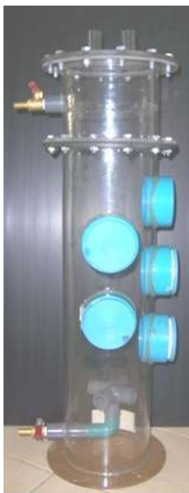
รูปที่ 3.3 รูปถ่ายเซลล์เชื้อเพลิงจุลชีพแบบห้องเดี่ยวที่ใช้ในงานวิจัย
