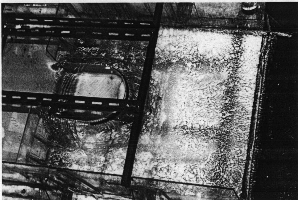
รูป ช-3 สภาพการไหลทางด้านท้ายของสันฝายแนว U
