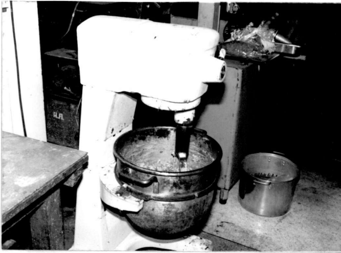
รูปที่ 4 การนวดเนื้อหมูในเครื่อง นวดผสม
