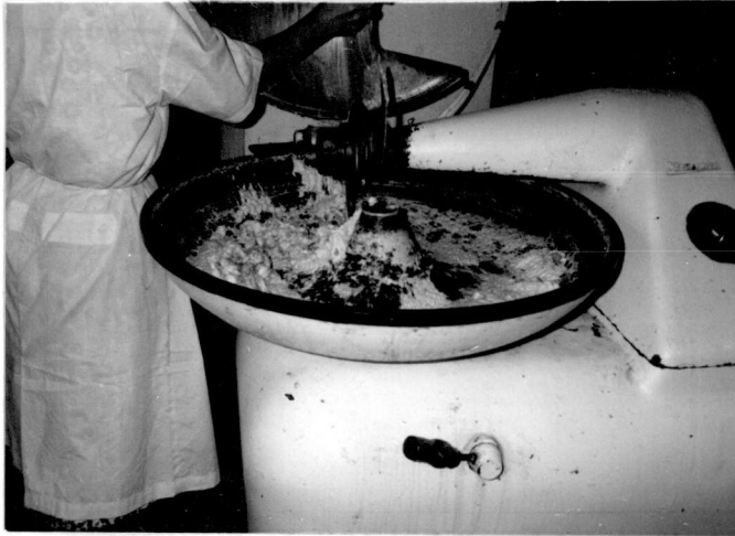
รูปที่ 5 การสับ เนื้อหมอบด มันหมอบด น้ำตาล น้ำแข็งบด ในเครื่องสับนวด
