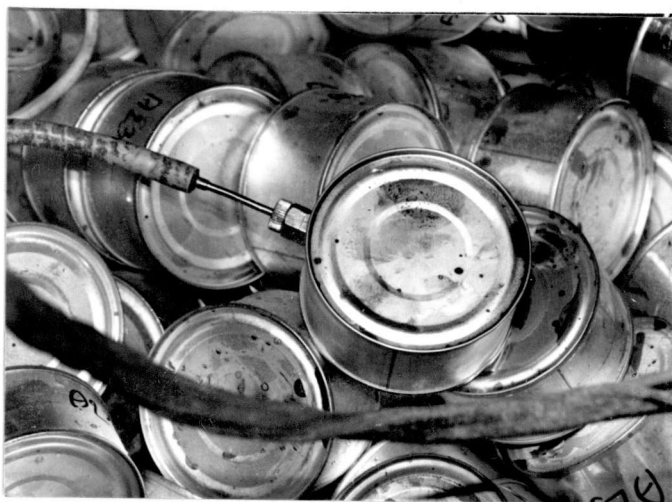
รูปที่ 19 การเสียบ thermocouple ในการหาค่า F o
