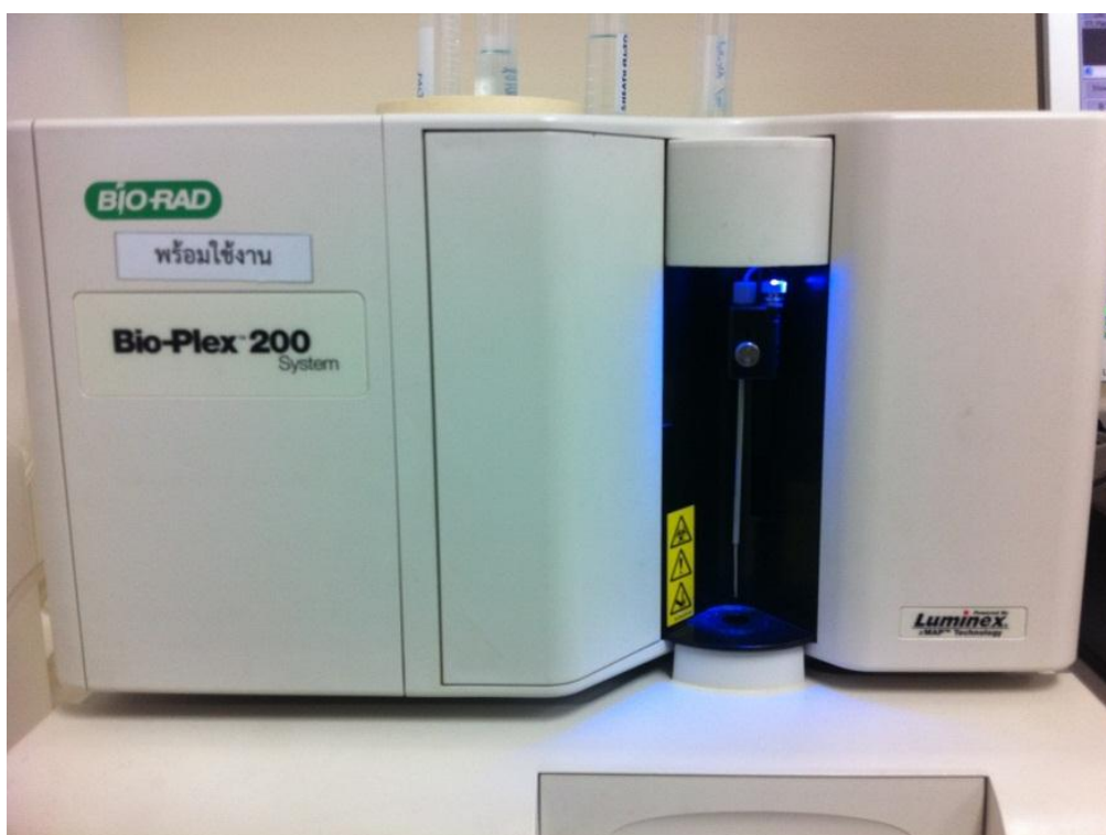
รูปที่ 11: แสดงรูปอุปกรณ์ เครื่องอ่าน เพื่อทำการตรวจวิเคราะห์หาระดับTh1/2 ไชโตไคน์ Biorad, Bio-Plex 200 system.
