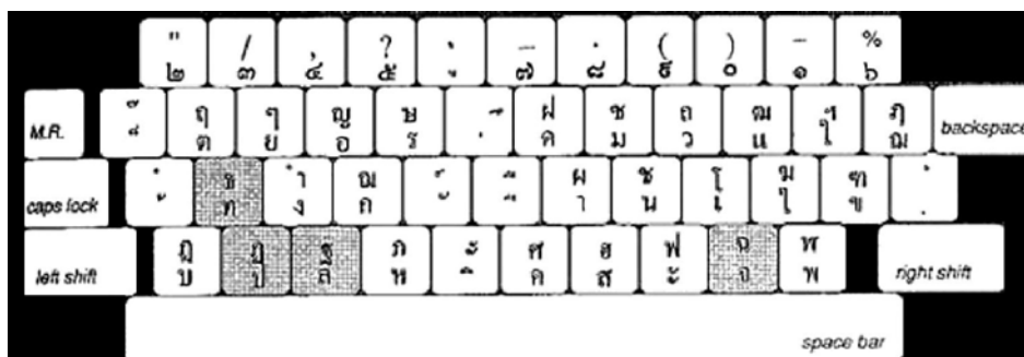
รูปที่ 2.5 แป้นพิมพ์แบบ “ปัดตะไต” (สมบุญณ์ แซ่เจ็ง, 2554)
