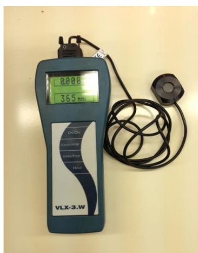
ภาพที่ 3.3 เครื่องวัดความเข้มแสงยูวี
