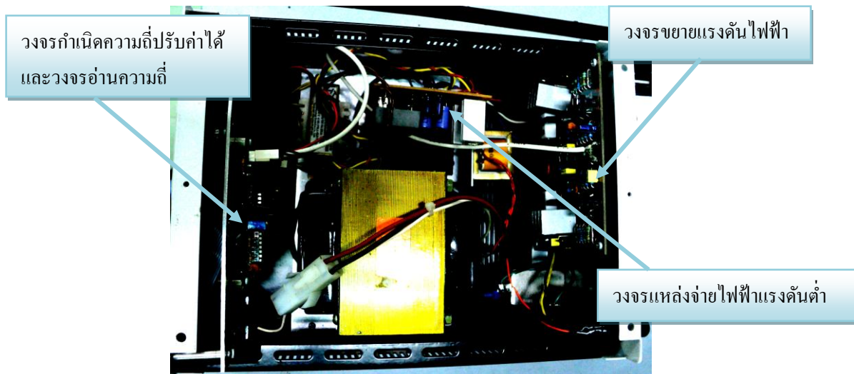
ภาพที่ 3.6 ส่วนประกอบภายในของเครื่องกำเนิดสัญญาณไฟฟ้ากระแสสลับ
