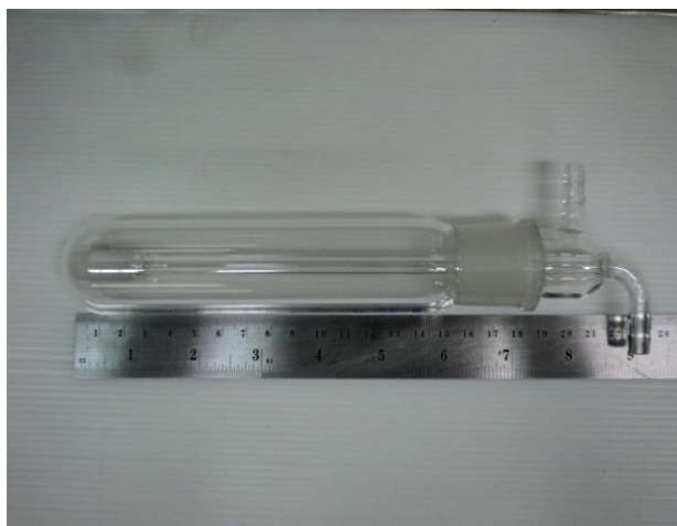
ภาพที่ 4.13 เครื่องแก้วสำหรับดักจับก๊าซหนัก
