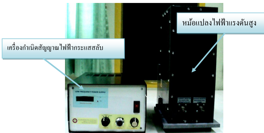
ภาพที่ 3.3 แหล่งจ่ายไฟฟ้ากระแสสลับแรงดันสูงย่านความถี่ต่ำที่ออกแบบขึ้น
