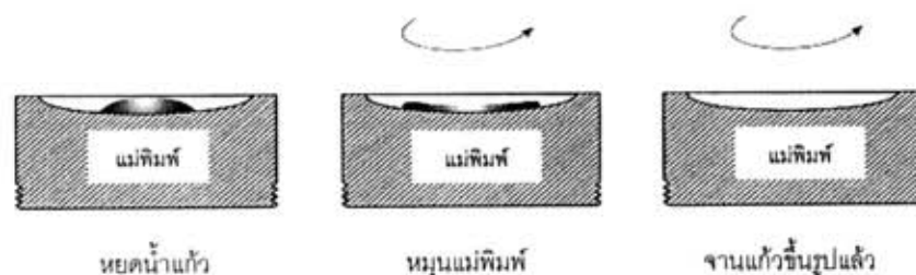
รูปที่ 3.31 วิธีขึ้นรูปบรรจุภัณฑ์แก้วแบบ Spin Forming
