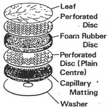
ภาพที่ 2.3 ผังแสดงตำแหน่งของแผ่นใบและอุปกรณ์ต่างๆ ภายใน leaf chamber
