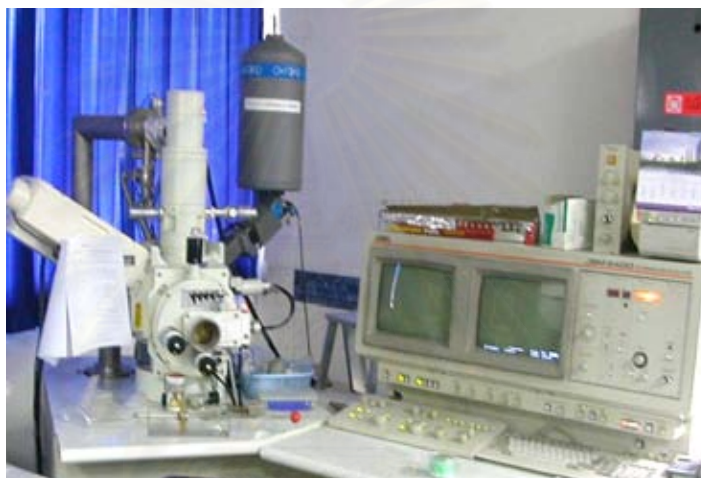
รูปที่ 3.12 กล้องจุลทรรศน์อิเล็กตรอนแบบส่องกราด รุ่น JSM-6400
