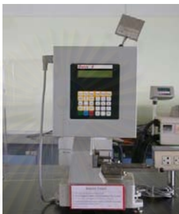
รูปที่ 3.10 เครื่อง Zwick 5102 Pendulum Impact Tester
