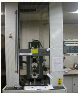
รูปที่ 3.6 เครื่อง LLOYD Universal Testing Machine model LR 100K
