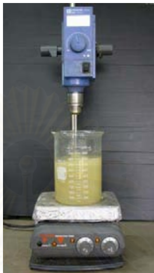
รูปที่ 3.2 ลักษณะของเครื่องมือที่ใช้ในการดัดแปรแป้ง
