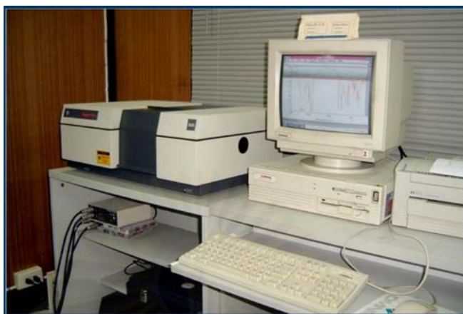
รูปที่ 3.3 เครื่องฟูเรียร์ทรานสฟอร์มอินฟราเรดสเปกโทรโฟโตมิเตอร์ (Nicolet –Impact 400)
