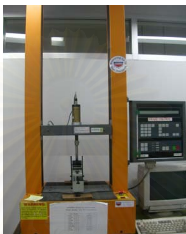
รูปที่ 3.8 เครื่อง LLOYD Universal Testing Machine model 500
