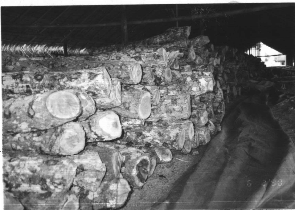
ภาพที่ 2.3 แสดงการวางไม้แบบซ้อนกันตามแนวยาว
