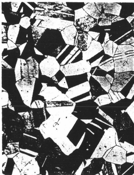
รูปที่ 43 แสดงภาพเกรนของทองแดงขยาย 100 เท่า (48)
