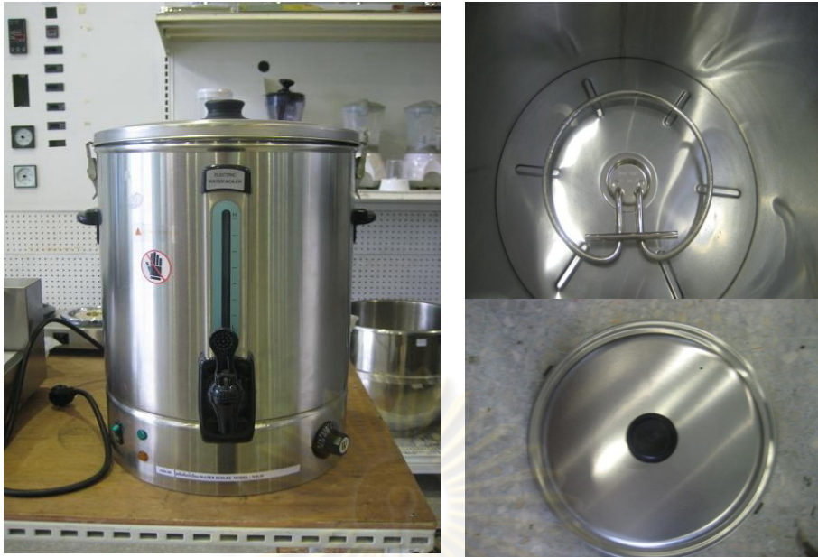
รูปที่ 3.10 การดัดแปลงหม้อต้มน้ำร้อนที่ใช้ในระบบผลิตน้ำร้อน
