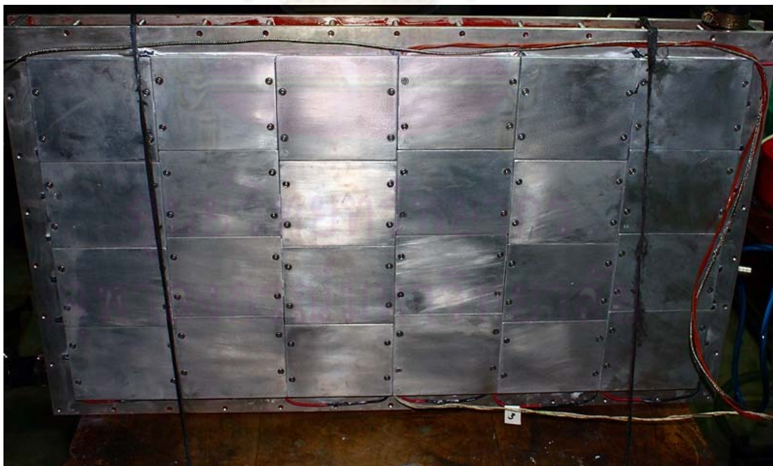
รูปที่ 3.13 โมดูลผลิตไฟฟ้าที่ประกอบสมบรูณ์บนอุปกรณ์แลกเปลี่ยนความร้อนสำหรับผนังเซลล์ด้านเย็น
