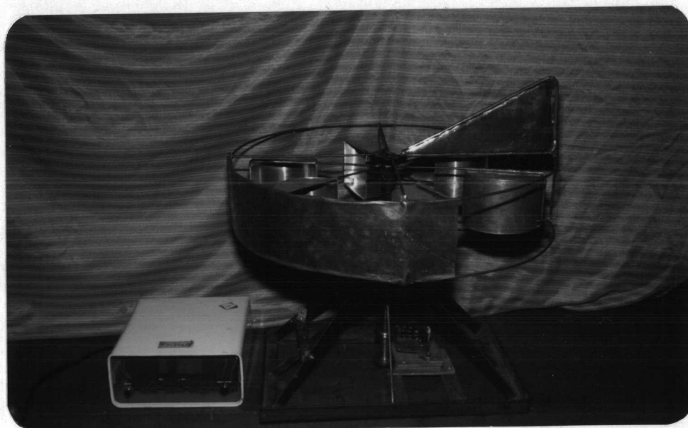
รูปที่ 5.4 ภาพถ่ายกังหันลมที่ประกอบกับเครื่องนับรอบ
