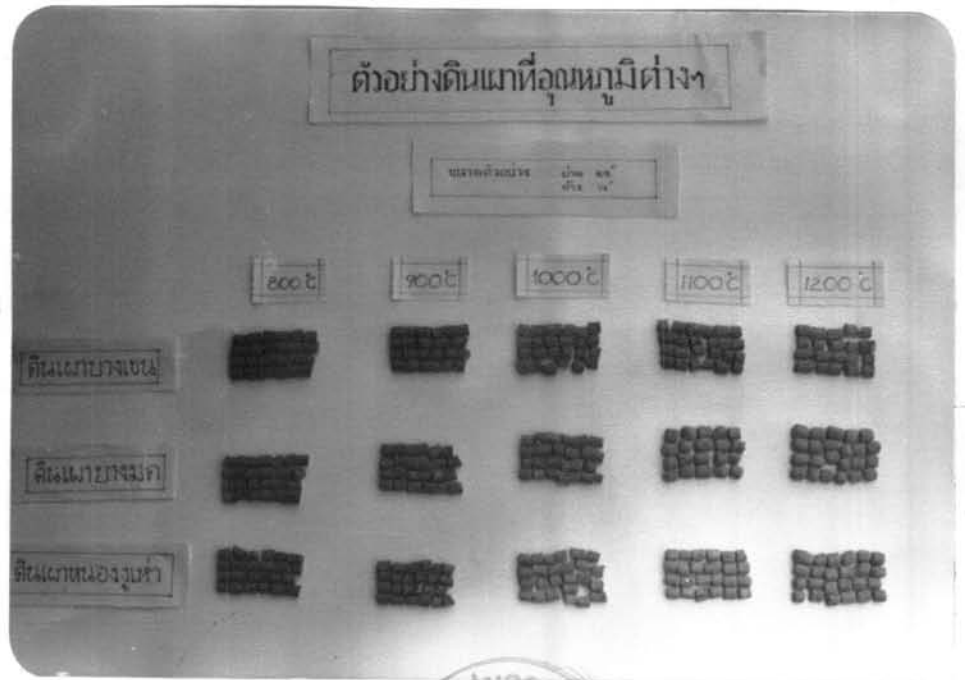
รูปที่ 3.4 ตัวอย่างกรวดดินเผา ที่อุณหภูมิต่างๆ
