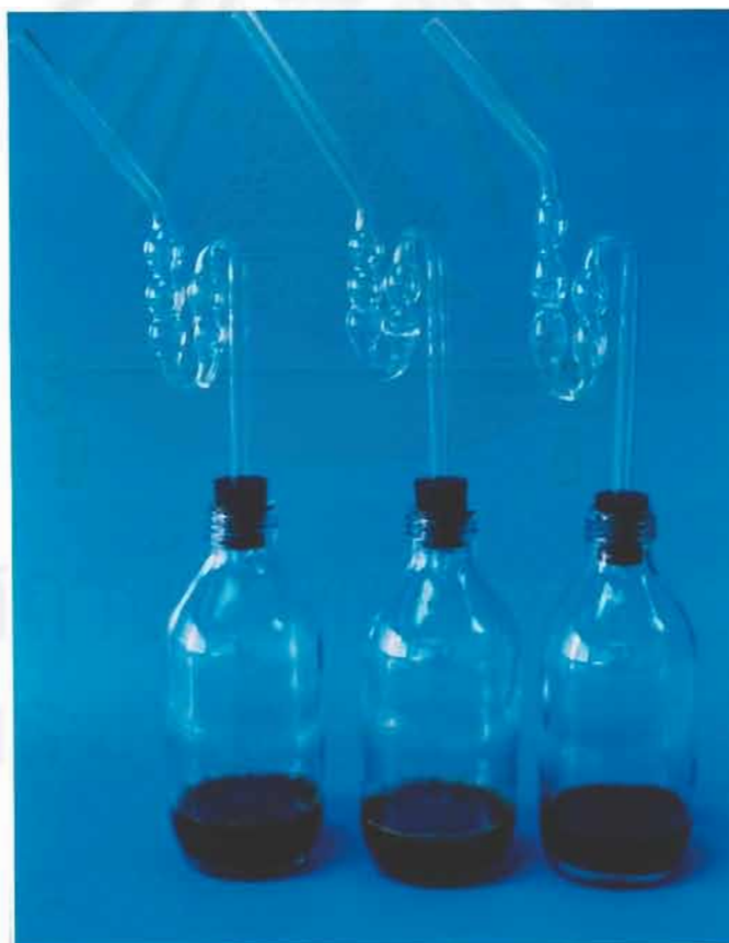
รูปที่ 2.1 ลักษณะขวดหมักเอทานอลและกระเปาะแก้วที่ใช้ในการทดลอง
