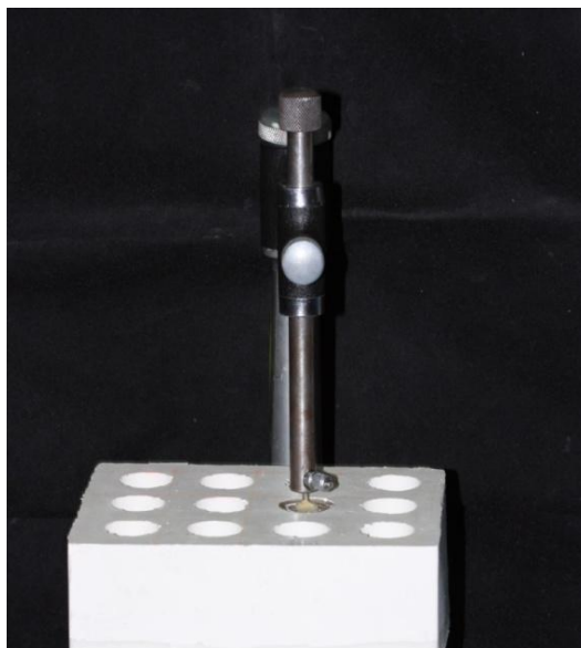
ภาพที่ 8 แสดงการลงบล็อคดีดพื้นโดยใช้เครื่องสำรวจความขนาน (surveyor)
