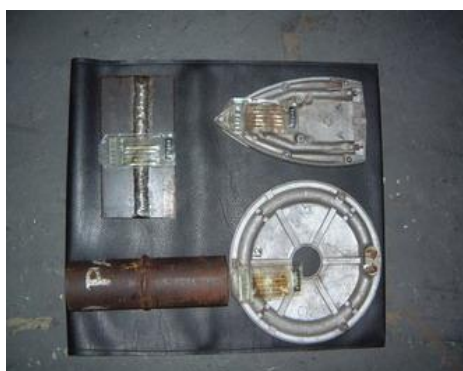
รูปที่ 2.10 ตัวอย่าง ชิ้นงานที่นำมาตรวจสอบด้วยรังสีเอกซ์
