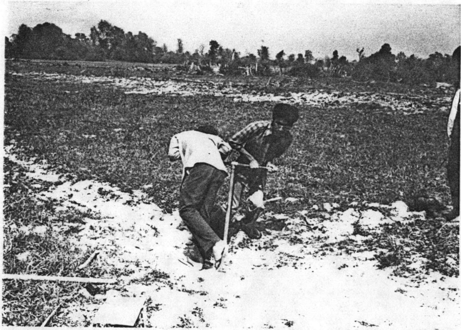
รูปที่ ๑-๑ วิธีการเจาะสำรวจดิน เพื่อคุณภาพดิน และระดับน้ำใต้ดิน
