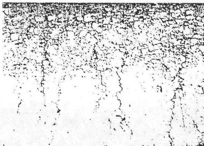
ค) Intergranular attack ที่เป็นสาเหตุของการเกิด Stress corrosion cracking ขนาดกำลังขยาย 100 เท่า
