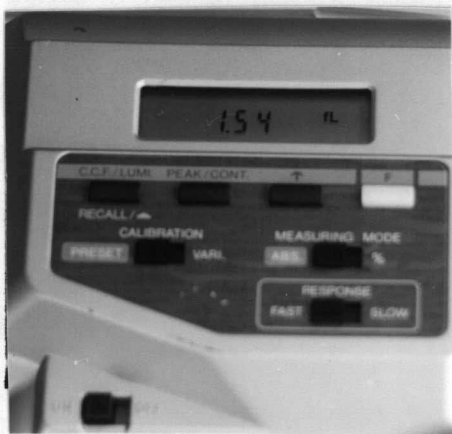
รูปที่ 8 แสดงลักษณะเครื่องมือ Brightness Meter ใช้วัดค่าความจ้า (Brightness) ในการทดลองวิจัย
