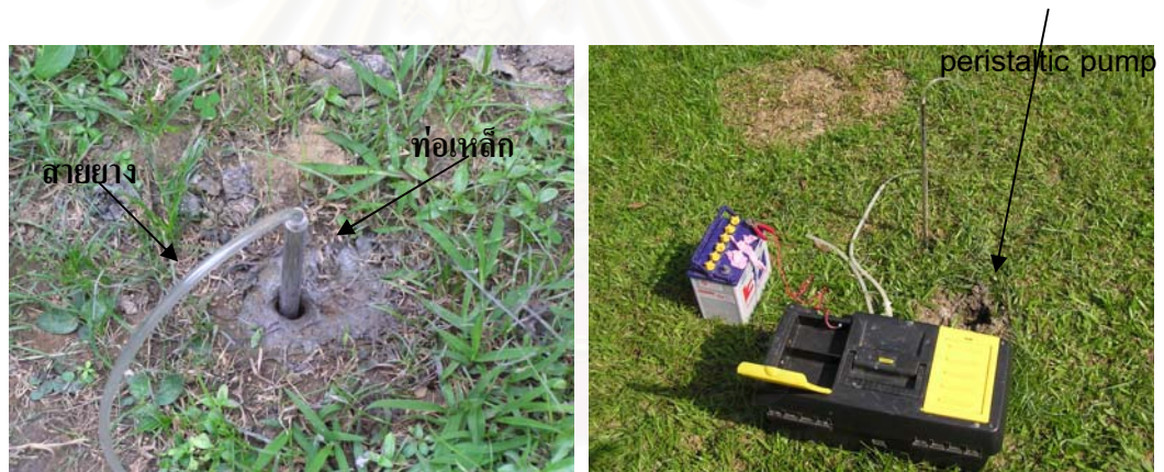
รูปที่ 3.5 การติดตั้งอุปกรณ์ RAD7 ตรวจสอบวัดปริมาณก๊าซเรดอนจากคลองบางกอกใหญ่
