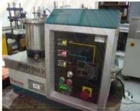
รูปที่ 2.11: เครื่องผสมความเร็วสูง (High speed mixer)
