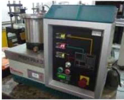
(ก) เครื่องผสมความเร็วสูง (High speed mixer)
