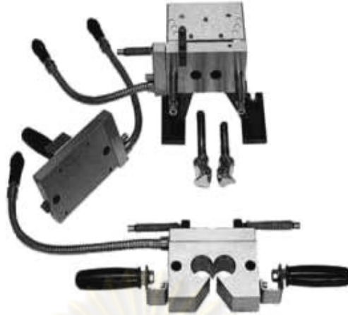
รูปที่ 2.19: ส่วนประกอบเครื่องทอร์ก รีโอมิเตอร์ (Torque rheometer)
