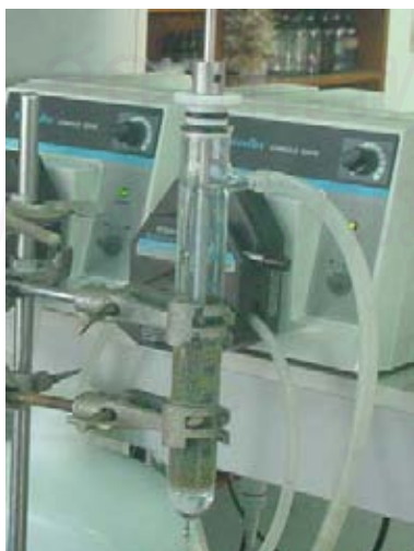
รูปที่ 3.5 คอลัมน์แก้วที่ใช้ในการทดลอง
