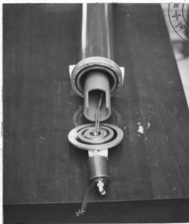
รูป 3.5 การประกอบความต้านทานภาคแรงสูงแบบฟิล์มโลหะออกไซด์
