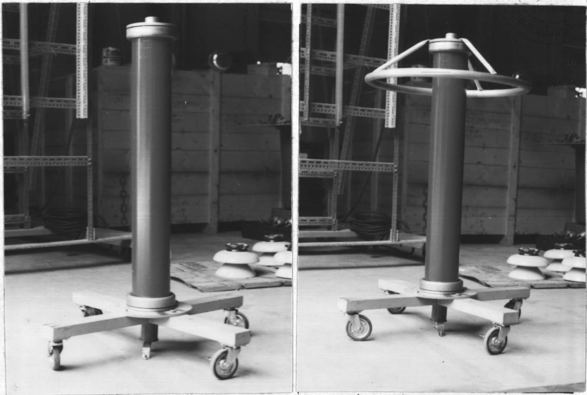
รูป 3.12 ลักษณะของอิมพัลส์โวลเตจดีไวเซอร์ขนาด 300 กิโลโวลท์
