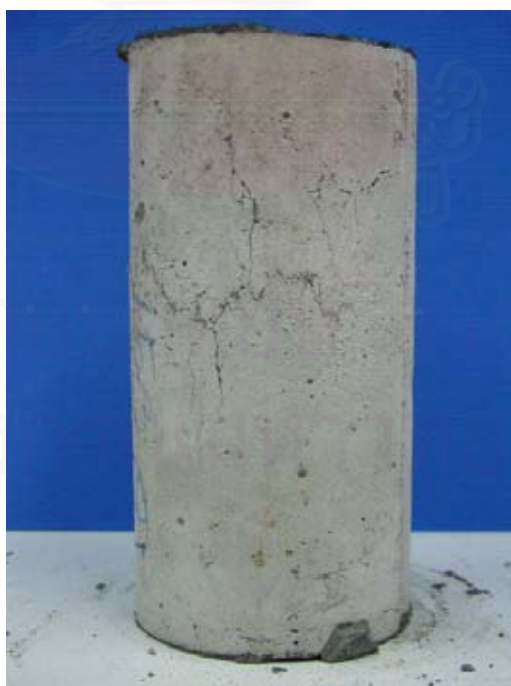
ภาพที่ 4.7 แสดงตัวอย่างคอนกรีตที่ 1 กลุ่มที่ 3 ภายหลังจากทดสอบกำลังรับแรงอัด
