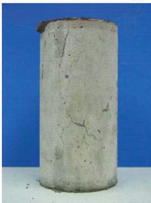
ภาพที่ 4.5 แสดงตัวอย่างคอนกรีตที่ 1 กลุ่มที่ 1 ภายหลังจากการทดสอบกำลังรับแรงวัฏจักร
