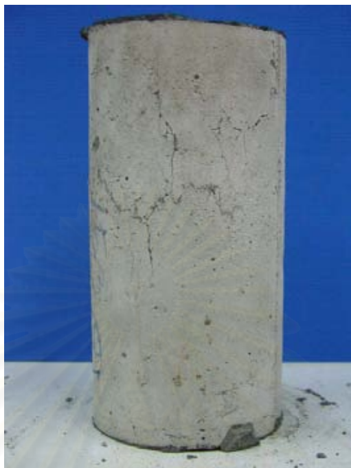
ภาพที่ 4.6 แสดงตัวอย่างคอนกรีตที่ 1 กลุ่มที่ 2 ภายหลังจากทดสอบกำลังรับแรงอัด
