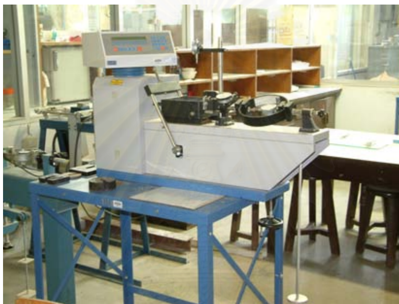
รูปที่ 3.5 แสดงเครื่องทดสอบ Direct Shear
