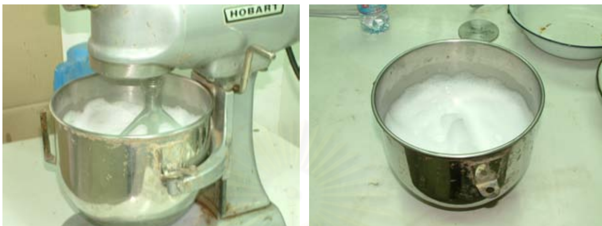
รูปที่ 3.4 แสดงวิธีการปั่นโฟม และตัวอย่างโฟม หลังจากปั่นเสร็จ แล้ว
