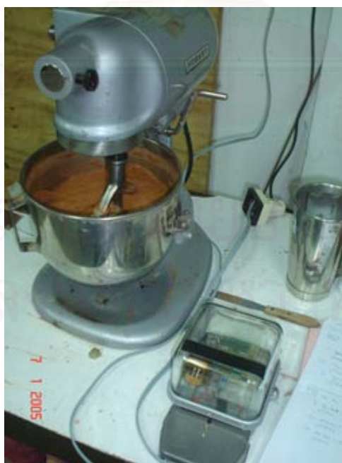
รูปที่ 3.11 แสดง การวัดพลังงานที่ใช้ในการปั่นตัวอย่าง โดยเครื่อง TOU Meter
