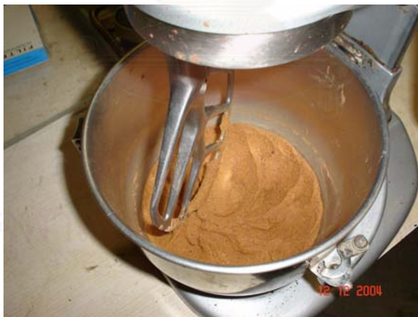
รูปที่ 3.6 แสดงการผสม ทราย กับ โฟม เข้าด้วยกัน ด้วยเครื่อง ผสมดิน
