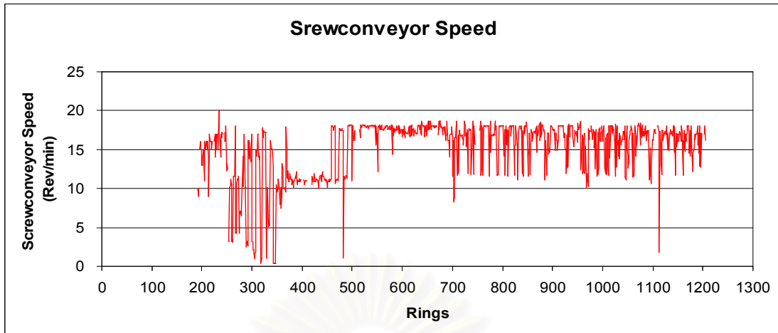
รูปที่ 4.15 (e) ค่า Screwconveyor Speed (Rev / minute) ที่ Ring No. 192 – Ring No. 1205
