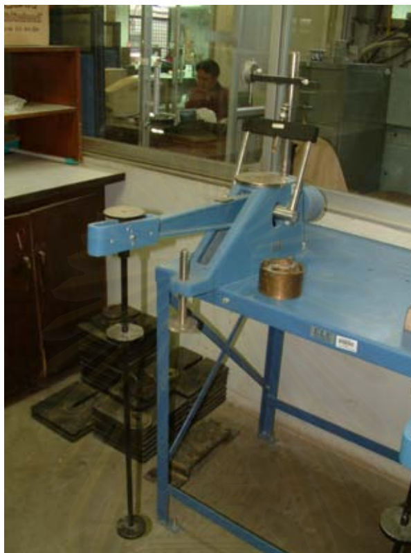
รูปที่ 3.8 แสดงเครื่อง Oedometer ใช้ทดสอบหา Compressibility ของตัวอย่าง
