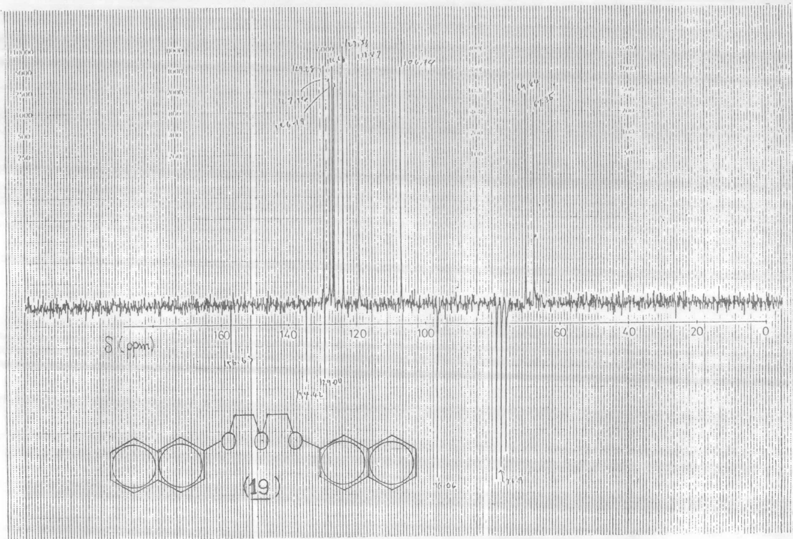
รูปที่ 14 ^{13}\text{C} partial relax fourier transform spectrum ของโพลิฮีเรอร์ (19) ใน \text{CDCl}_3 + \text{CCl}_4
