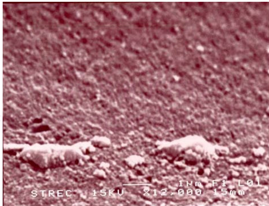
รูปที่ 4.8 พื้นผิวของซิลิกาเจลเคลือบเหล็กออกไซด์แบบที่ 2 (กำลังขยาย 12,000 เท่า)
