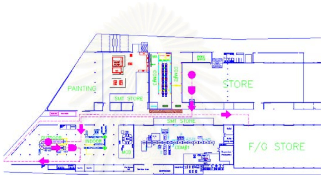
รูปที่ 3.9 แผนภูมิการไหลของสายการผลิต Outdoor
