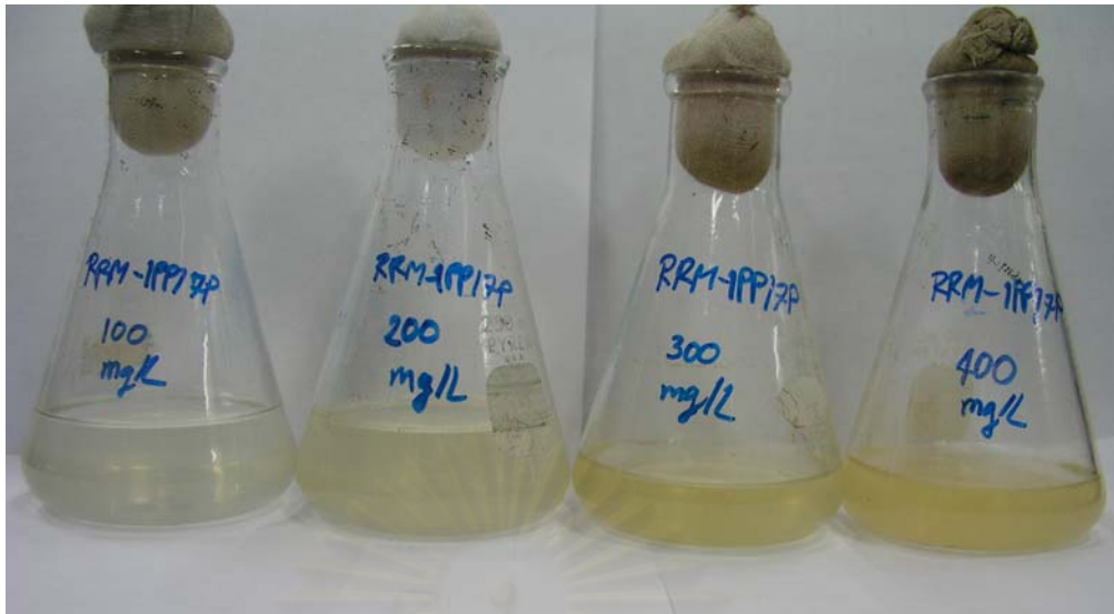
รูปที่ 4.6 แสดงลักษณะอาหารเหลวที่มีสีน้ำตาลจากการเพิ่มความเข้มข้นของไฟรีนเป็น 200 300 และ 400 มก.ต่อลิตร ซึ่งสีน้ำตาลเข้มขึ้น
