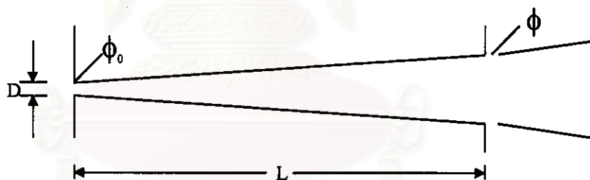
รูปที่ 2.24 แสดงภาพวาดอย่างง่ายของคอลลิเมเตอร์แบบไดเวอร์เจนต์ ที่มีช่องเปิดทางเข้า D และความยาวของคอลลิเมเตอร์ L [6]
