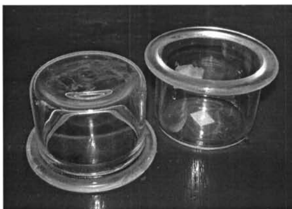
รูปที่ 3.2 ถ้วยแก้วปากแบนในชุดอุปกรณ์ทดสอบสภาพการนำซึมน้ำผ่านได้ของน้ำ
