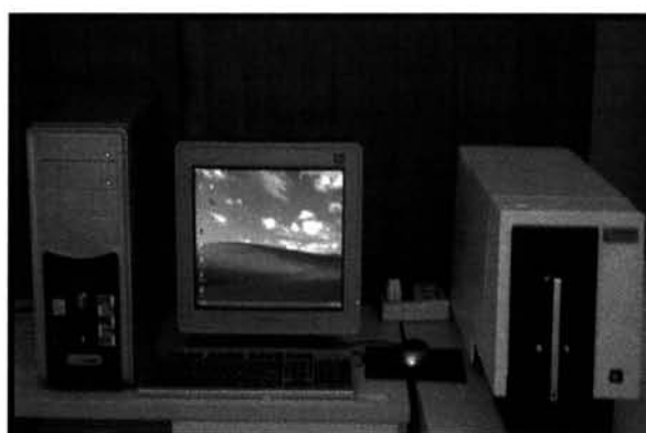
รูปที่ 3.8 เครื่องวัดสีของ Macbeth Color-Eye 7000
