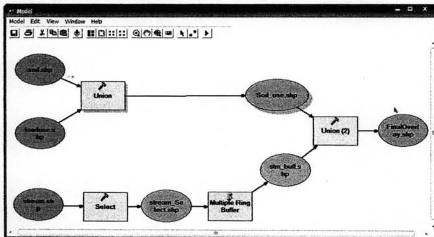
20. กำหนดค่า Output Feature ของ Union(2) โดยการคลิกขวา และกำหนดค่าเป็น
