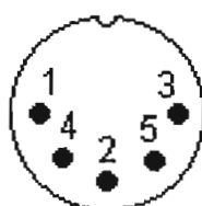
รูปที่ 4.3 แผงแป้นอักขระบนตัวเชื่อมต่อ [13]
