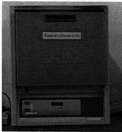
รูปที่ 3.5 เตาเผาไฟฟ้า (muffle furnace)
