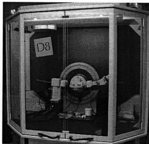
รูปที่ 3.7 เครื่องเอกซเรย์ดิฟแฟร็กโตมิเตอร์ รุ่น JDX-8030 ยี่ห้อ JEOL
