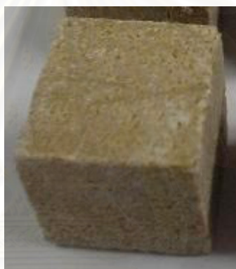
รูปที่ 4.12 พูนปั้นเก่าก่อนทำการทดลอง
