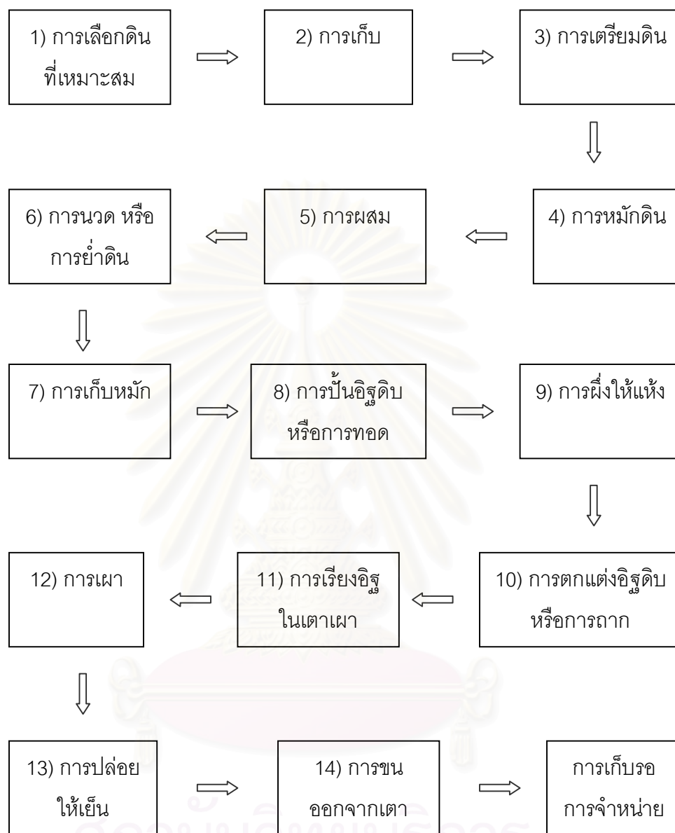
รูปที่ 2.3 แสดงแผนภูมิกรรมวิธีในการผลิตอิฐ
