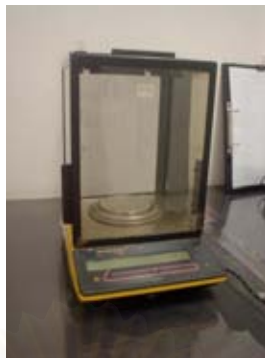
รูปที่ 3.4 เครื่องชั่งละเอียด ของ Sartorius รุ่น BA210S
