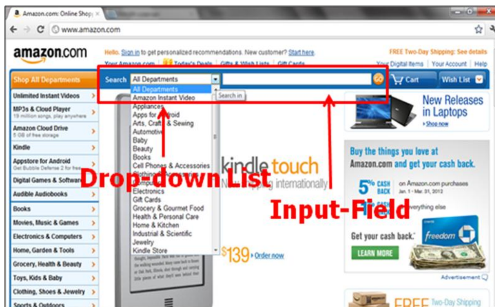
ภาพที่ 1.5 ตัวอย่างแบบฟอร์มการค้นหาข้อมูลออนไลน์ที่มีการใช้รายการเลือก (Drop-down List) (เว็บไซต์ www.amazon.com, 2012)
