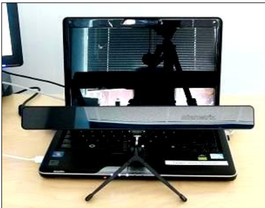
ภาพที่ ค.3 การติดตั้งอุปกรณ์การเชื่อมต่อของเครื่องมือติดตามการมองเห็น กรณีที่ใช้คอมพิวเตอร์พกพา (Computer Laptop)
