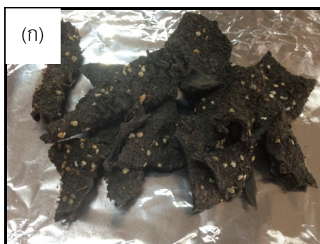
ภาพที่ 3.1 (ก) กากตะกอนจากการบำบัดน้ำเสีย และ (ข) กากตะกอนที่ผ่านการทำความสะอาดแล้ว
