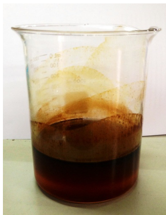
ภาพที่ 3.2 กลีเซอรอลดิบที่เกิดจากกระบวนการผลิตไบโอดีเซลโดยใช้น้ำมันพืชหรือสัตว์ที่ผ่านการใช้งานแล้วเป็นสารตั้งต้น
