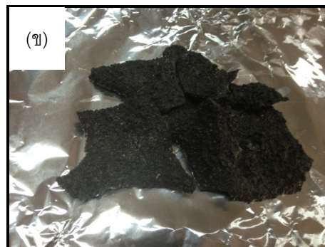
ภาพที่ 3.1 (ก) กากตะกอนจากการบำบัดน้ำเสีย และ (ข) กากตะกอนที่ผ่านการทำความสะอาดแล้ว
