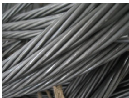
ภาพที่ 6 ลวดอัดแรงที่ใช้ในโครงสร้างพื้นโพสเทนชัน
