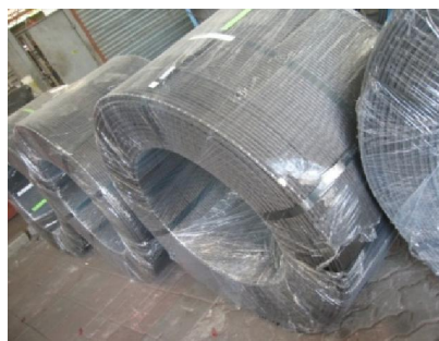
ภาพที่ 6 ลวดอัดแรงที่ใช้ในโครงสร้างพื้นโพสเทนชัน
